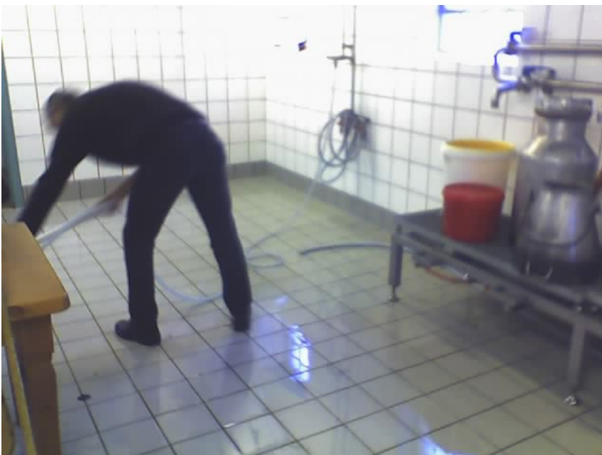
Figur 22 Spuling med koldt vand. Rengøring af alt. Svabning. Renkøring af rørsystemer.
