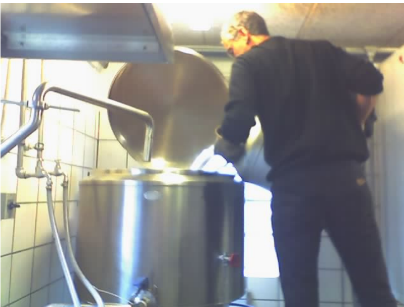
Figur 12 Efterhældning af varmt vand.
